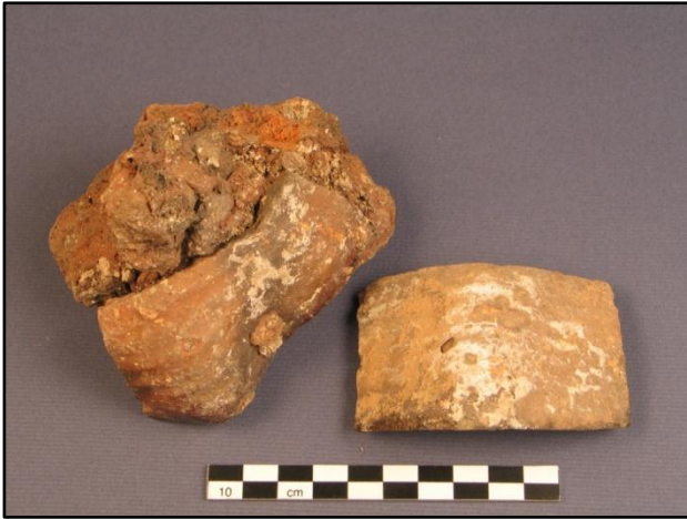
Ruukkukaakeleita. Vasemmanpuoleinen sulanut tiileen kiinni.
