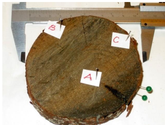
Kuva 5.23. Raakapuunäytteestä sahattu kiekko ilmakeivatuksen jälkeen. Mitatut kutistumissuunnat puun poikkileikkaussuunnassa: A-B (ja A-C) = radiaalinen, B-C = tangentialinen. Vihreät neulat = pituussuuntainen. Kuva Rami Kokko, Museovirasto.
