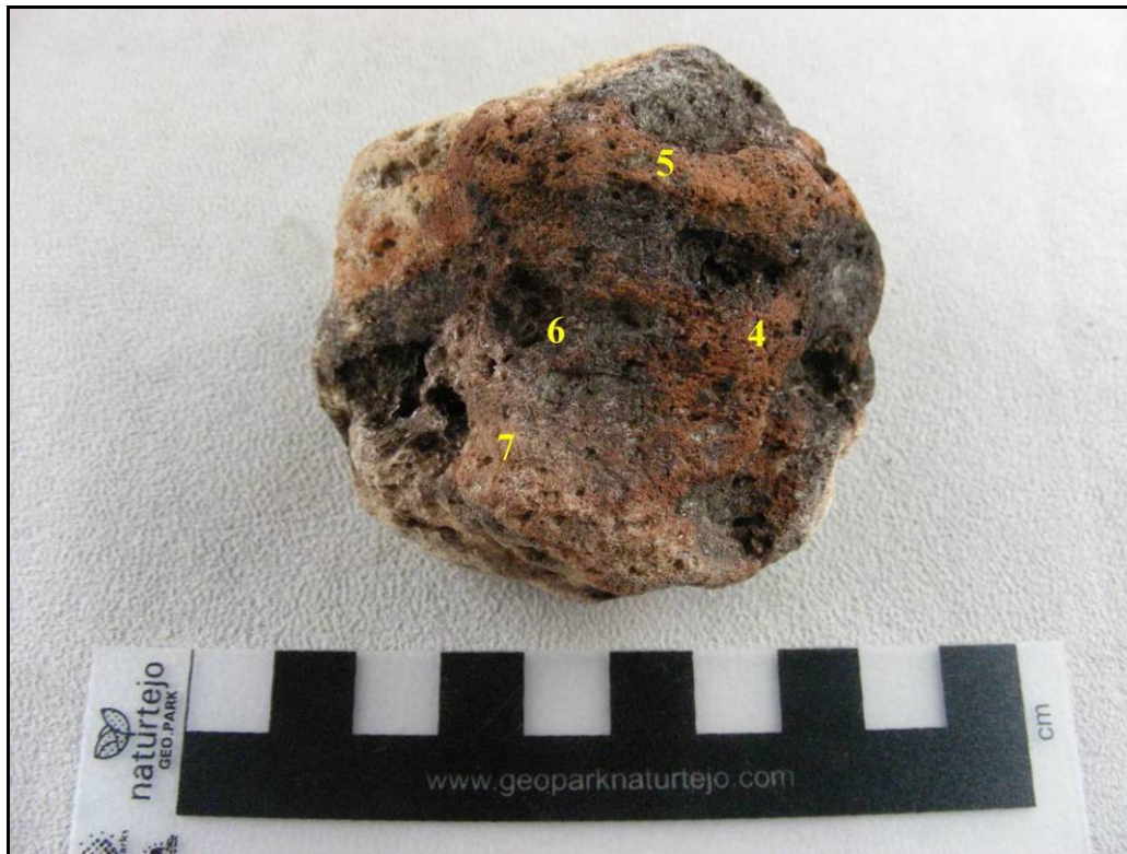
Kuva 11. Vrouw Marian hohkakiven XRF-analyysin mittauspisteet 4 – 7. Kuva: Satu Hietala.
