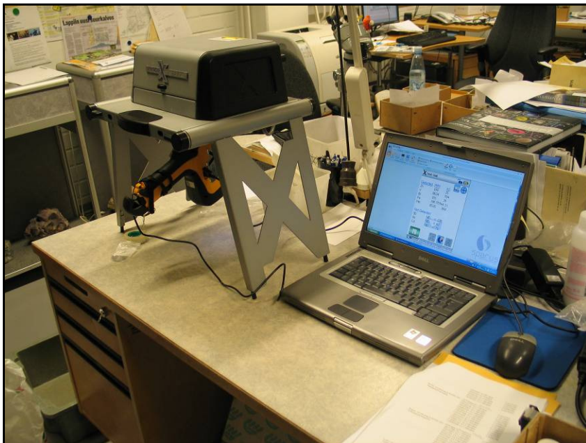
Kuva 9. GTK:n Kansannäytetoimiston XRF analyysaattori Delta Premium. Kuva: Satu Hietala.
