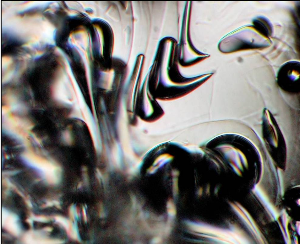
Kuva 4. Polarisatiomikroskooppikuva Vrouw Marian hohkakiven lasiaineksesta. Kaasukuplat voimakkaasti venyneitä lasin virtaussuunnassa. Plagioklaasi- ja pyrokseenikristalliitit ovat harvinaisia. Lasin devitrifikaatiota ei ole havaittavissa. Kuvalan leveys 0,23 mm. Kuva: Kari A. Kinnunen.
