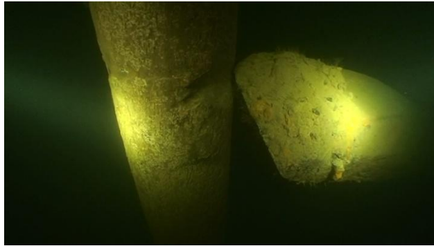
Kuva 22. Maston liikkumisesta aiheutunut hankausjälki keulamastossa. Pysäytyskuva Rami Kokon kuvaamasta videosta, Museovirasto (MA201108:76).
