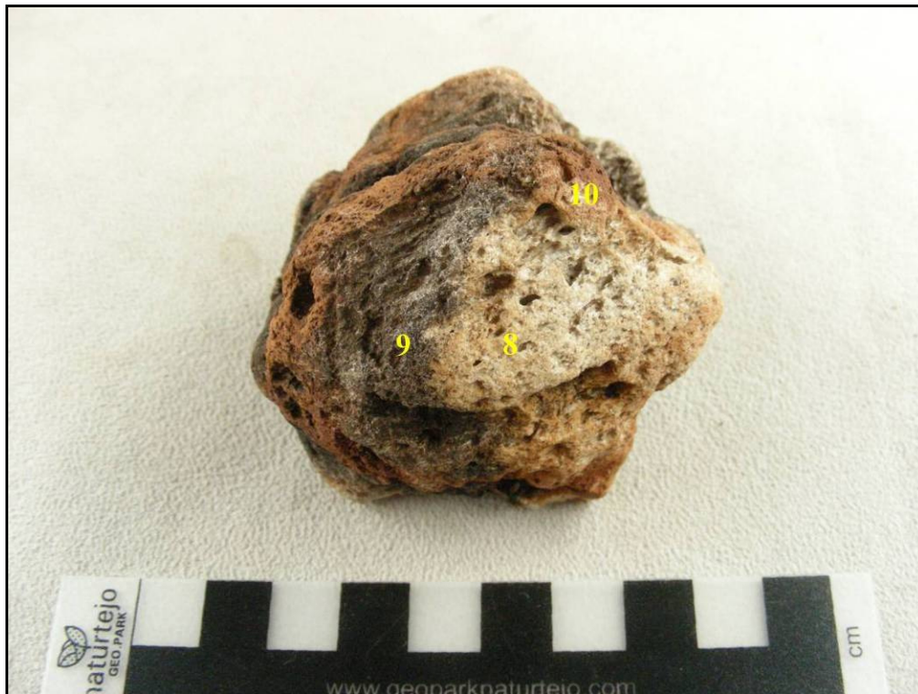
Kuva 12. Vrouw Marian hohkakiven XRF-analyysin mittauspisteet 8 – 9. Kuva: Satu Hietala.
