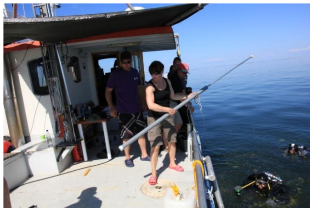
Kuva 5. Sedimenttinäytteenotossa käytetty putkinäytteenotin. Kuva Vesa Hautsalo, Museovirasto (MA201108:54).
