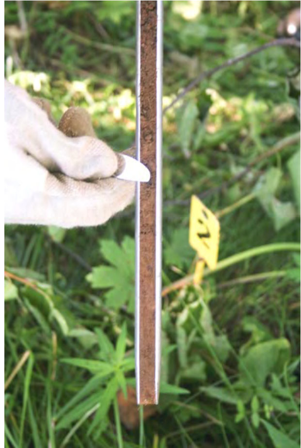
Kuva 14. Maaperäkemialliset näytteet otettiin kairaprofiilista peltokerroksen alapuoleisesta hietakerroksesta. Kuva: Satu Koivisto/MV (DG2717:58).
