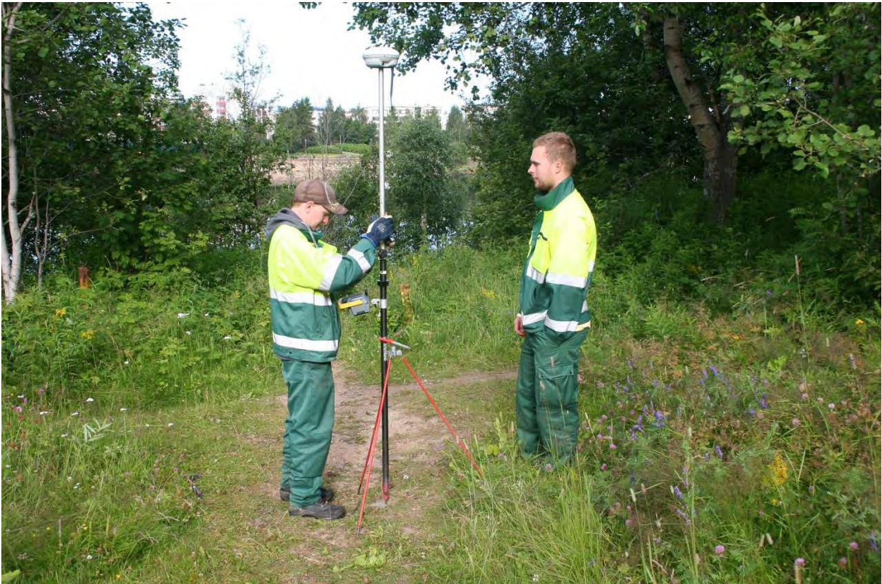
Kuva 10. Kaupungin mittamiehet laativat tutkimusalueelle neljä uutta kiintopistettä. Kuva: Satu Koivisto/MV (DG2717:3).
