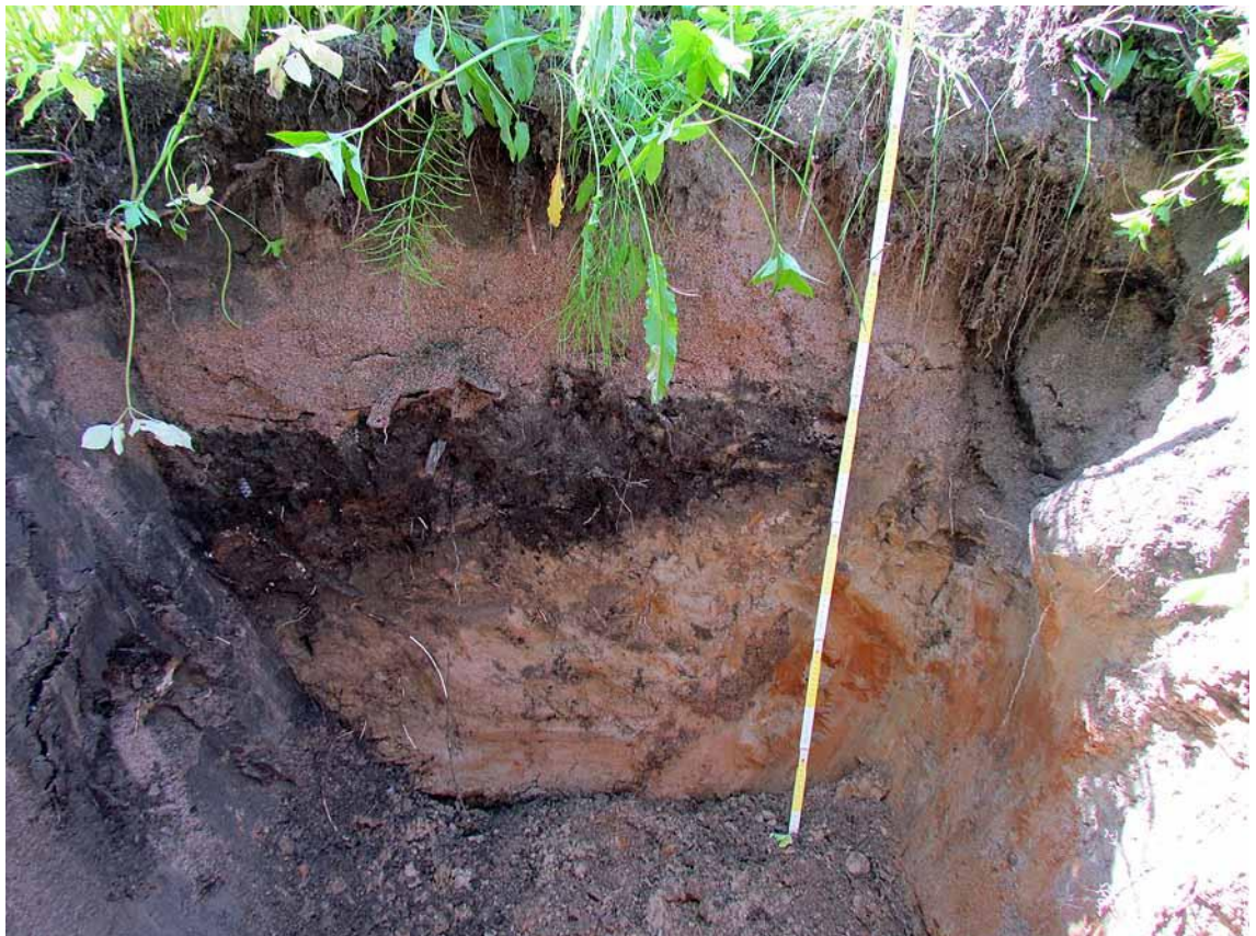
Kuva 21. Koekuoppassa havaittiin täyttökerroksia. Kalle Luoto 15.6.2012.
