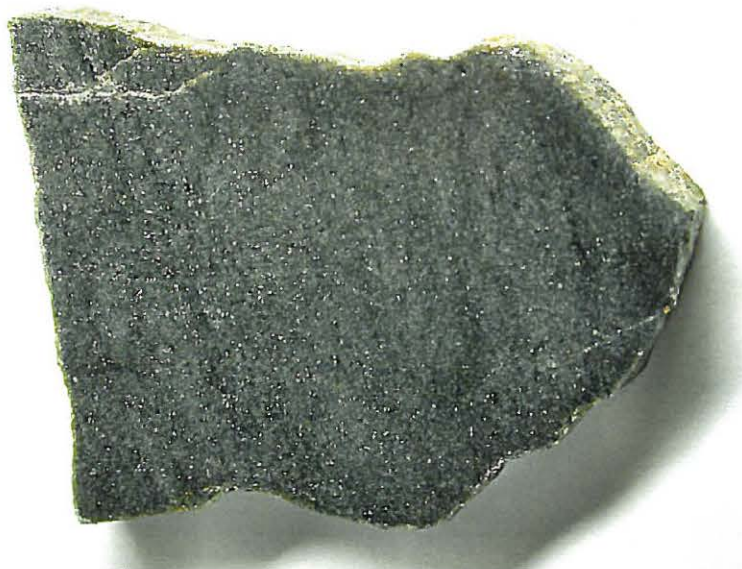
Kuva 4. Hyllyn kivisauvasta sahattu ja hiottu levynäyte. Kuvassa erottuu kiven ulkoreunoja ja hiushalkeamia ympäröivä muuttumisreunus. Kivilevyn leveys 5 cm. Kuva: Kari A. Kinnunen.
