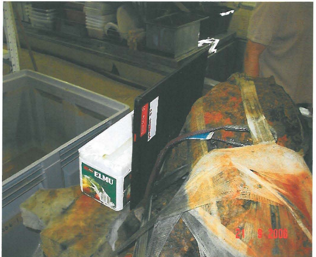
Kuva 1. Esimerkkikuva ”tynnyrimäisen” tutkimuskappaleen yhdestä röntgenkuvausjärjestelystä. Digitaalinen röntgenfilmi on kuvassa tutkimuskappaleen kylkeen kappaleeseen kosketukseen sijoitettuna ja säteilytys tulee vaakasuunnassa eli röntgenfilmin suuntaa vastaan kohtisuoraan.
