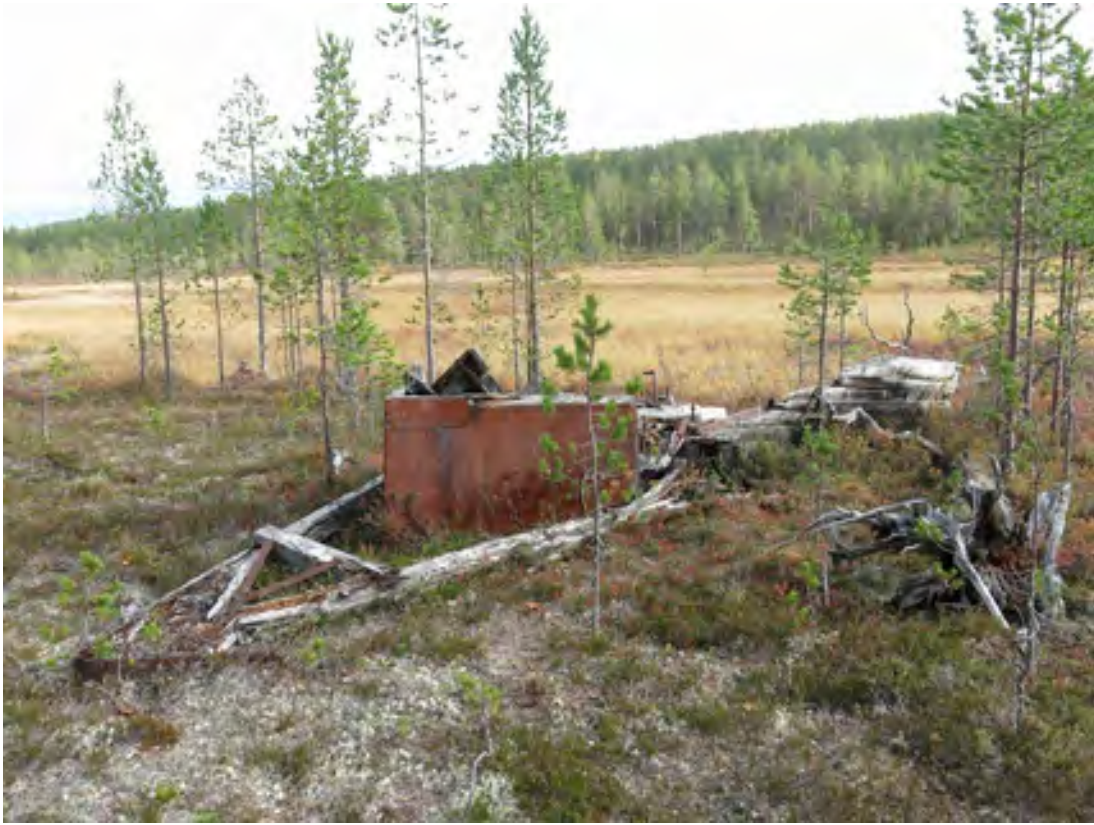
Kuva 347. Aurajängän savottajäännökset. Tukkitien auran jäännös. Auran kärki on vahvistettu peltilevyillä. Kuvattu lounaasta.
