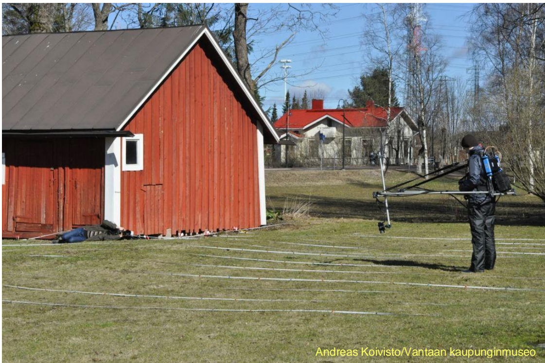
Kuva 5. Magnetometrimittauksia tehtiin 0,5 metrin välein. Kuvassa näkyvä mittausalueen 2 laidalla ollut rakennus aiheutti häiriöitä mittauksiin.
