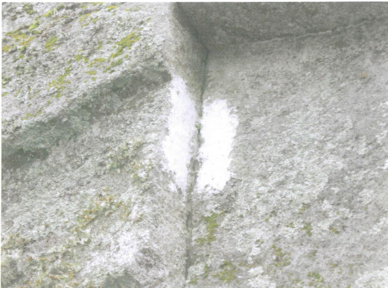
Det. B. Kukkarokiven pinnanpoistokohta, jossa pinnan poisto on tehty luontaista lustorailoa myöten, joten pinta on sileämpi kuin kuvion vasemmassa reunassa piikkaussauman avulla tehdyssä poistossa ( Det. B), jossa näkyy karhea piikkauksen jälki. Kuvassa maali on levinnyt tasaisesti kiven pinnalle, sitä vastoin toisen kuvan piikkausreunassa maali on vain ”piikeissä” ja näin se ilmaisee sen, että pintaa on ”kivityömies” käsitelty.
