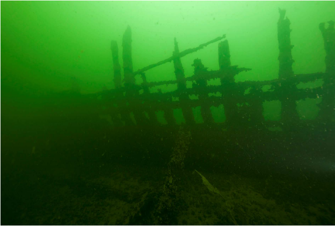
Kuva 2. Styyrpuurin puolen kylkeä kuvattuna aluksen keskivaiheilta kohti perää. Kylkikaaret nousevat pohjasta jopa neljä metriä. Alus on hyvin hauras.
