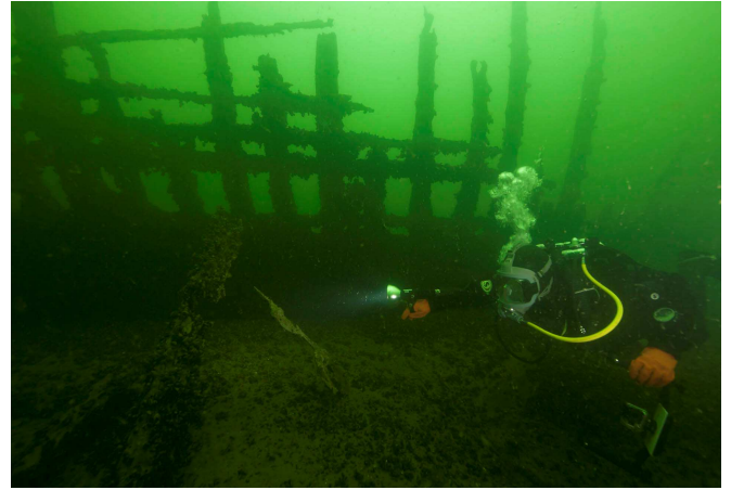
Kuva 3. Styyrpuurin puolen kylkeä keskilaivan kohdalla. Pohjalla makaa kaaren kappaleita ja kylkilankkuja. Pohjasedimentin sisällä on todennäköisesti runsaasti hyllyn kappaleita.
