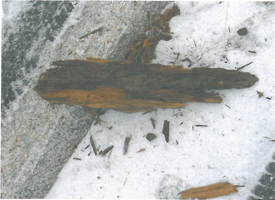
Kuva 10. Laudan kappale osoittautui asfalttitien rakentamiseen liittyväksi puurakenteen osaksi.
