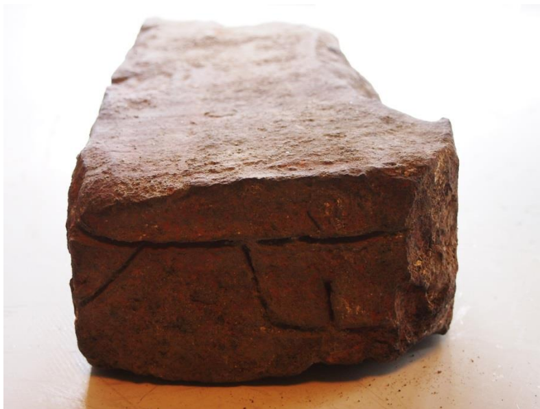
Kuva 29. Tiilentekijän avainmerkki irtotiilen päässä. Ilari Aalto.
