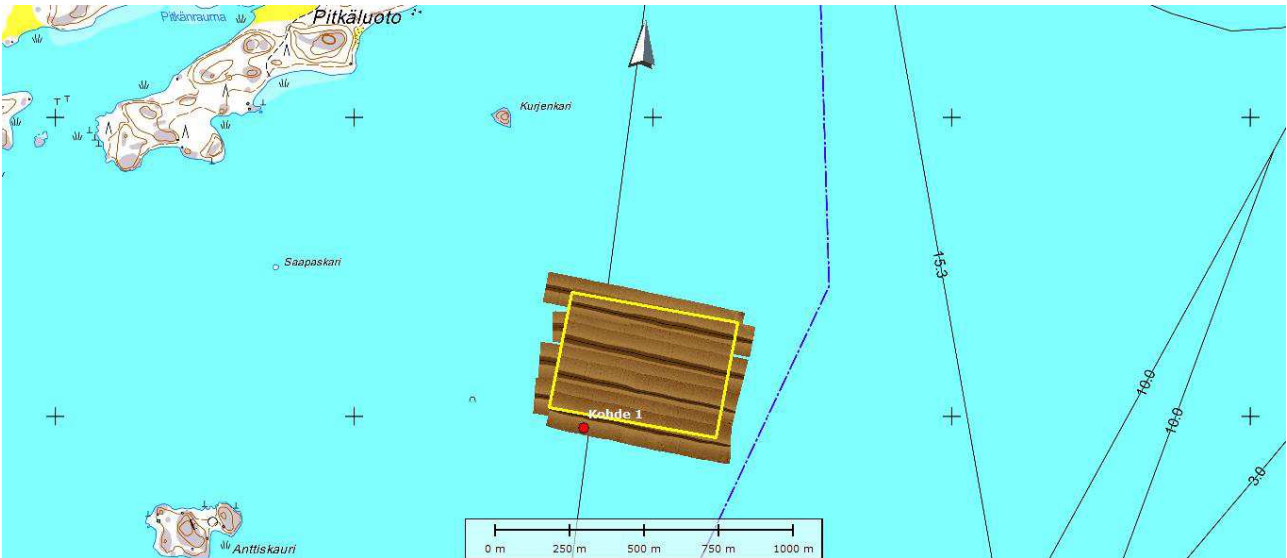
Kartta 3. Mosaiikkikuva viistokaikuluotauksen kattavuudesta tutkittavalla alueella. Karttaan on merkitty tutkimusalueen rajat keltaisella ja kohde 1 punaisella. Karttaphoja: MML peruskartta.
