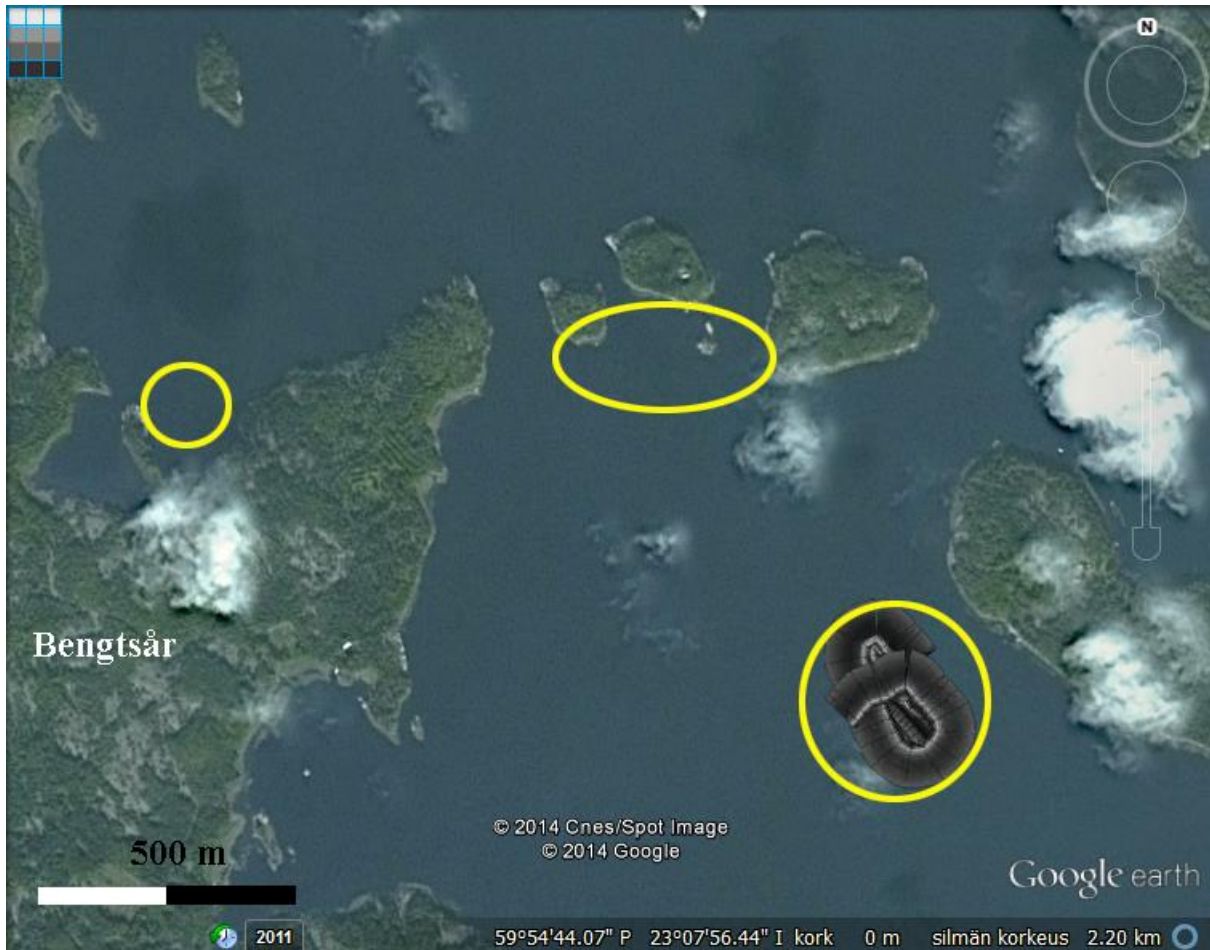
Kartta 6: Kamsholmsfjärdenin vesialueet: Viistokaikuluotausajot sijoitettuna kartalle. Alueet, joilla on suoritettu magnetometriluotausta ja tehty tarkastussukelluksia, on rajattu suuntaa antavasti keltaisella. Karttapohja Google Earth.
