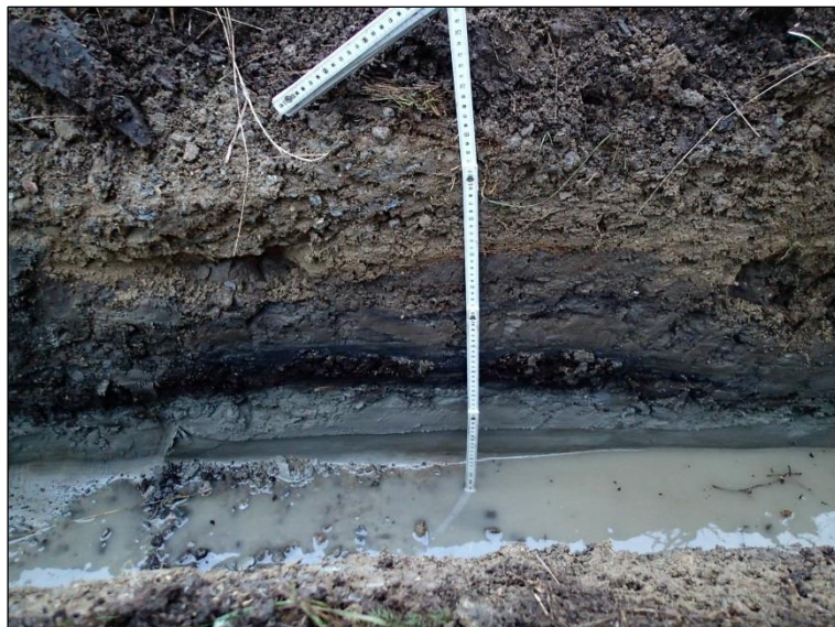
Kaivannon seinämää 2 m Nisulan talon seinästä. Pohjamaan päällä puunkuorikerros.
