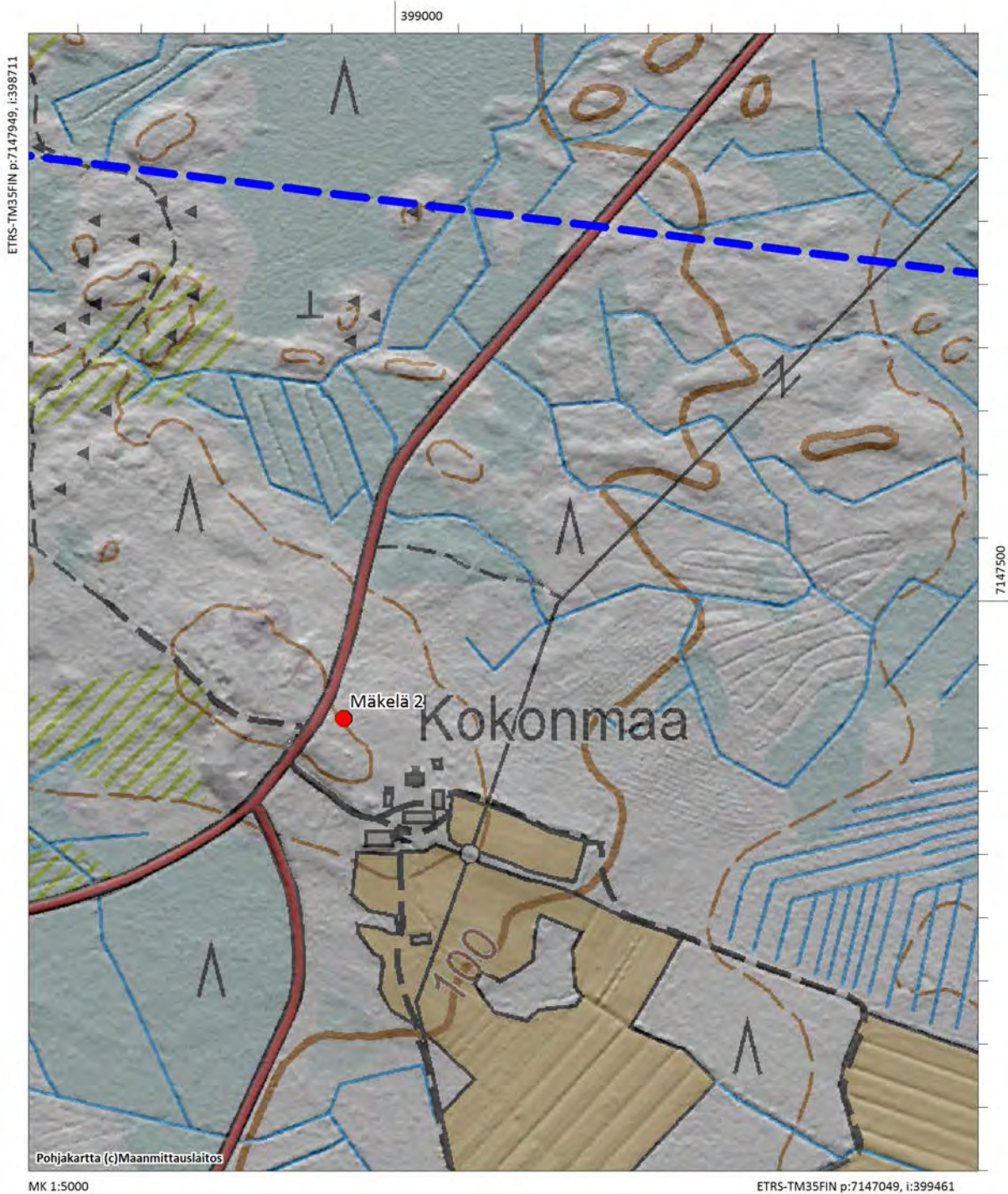
Ote peruskartasta, jonka alla on ilmalaserkeilausaineistosta tuotettu vinovalovarjoste, mittakaava 1:5000. Sininen katkoviiva = 400 kV voimajohdon suunniteltu linjaus.
