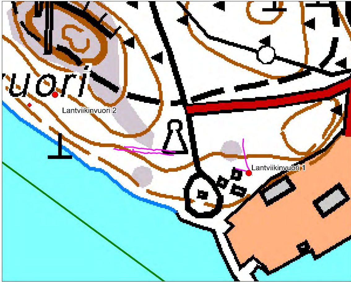
Lantviikinvuoren kohteilla tehdyt mittaukset, 1:2000. Lantviikinvuori 1: lila viiva = ojat. Lantviikinvuori 2: punainen ympyrä = kuopanne, punainen rombi = betonijalusta, lilat viivat = mahdollisen tienpohjan/kuljetusradan reunat.
