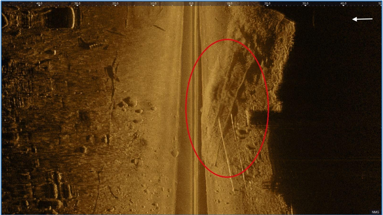
Kuva 18. Telakan raiteet kulkevat veteen pohjaan läjitetyn pengerryksen päällä. Kirkkaat suorat valkoiset anomaliat kuvassa raiteiden läheisyydessä ovat kelluvan aluksen pohjasta palautuneita kaikuja.
