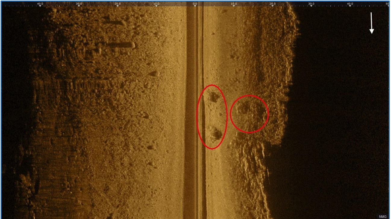
Kuva 7. Viistokaikuluotauskuva hirsikuista ja rannemmaksi (oikealla) kasatuista kivikasoista. Luonnollinen rantakivikko on häiriintynyt tällä alueella.
