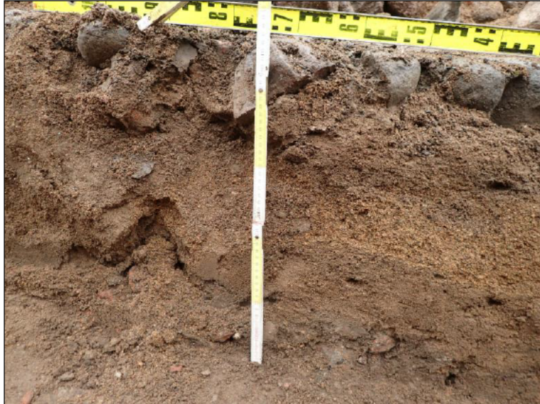
Kadun profiili, nupukiveyksen alla kaksi hiekkakerrosta ja sen alla sorainen kerros
