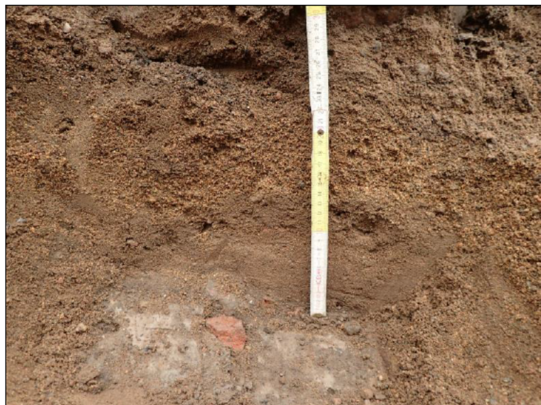
Kaivannon pohjaan tehty pieni koekuoppa josta paljastui täytemaiden alta tiiviimpi kerros jossa tiilen kappaleita ja hiilen muruja
