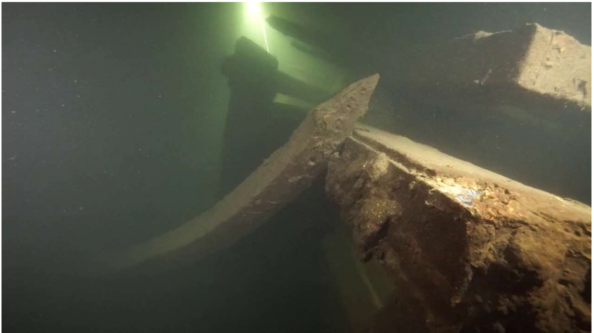
Kuva 33. Wing transom, peräranka, peräsin ja peräsinpinna. Ruutukaappaus videosta: Kari Hyttinen.
