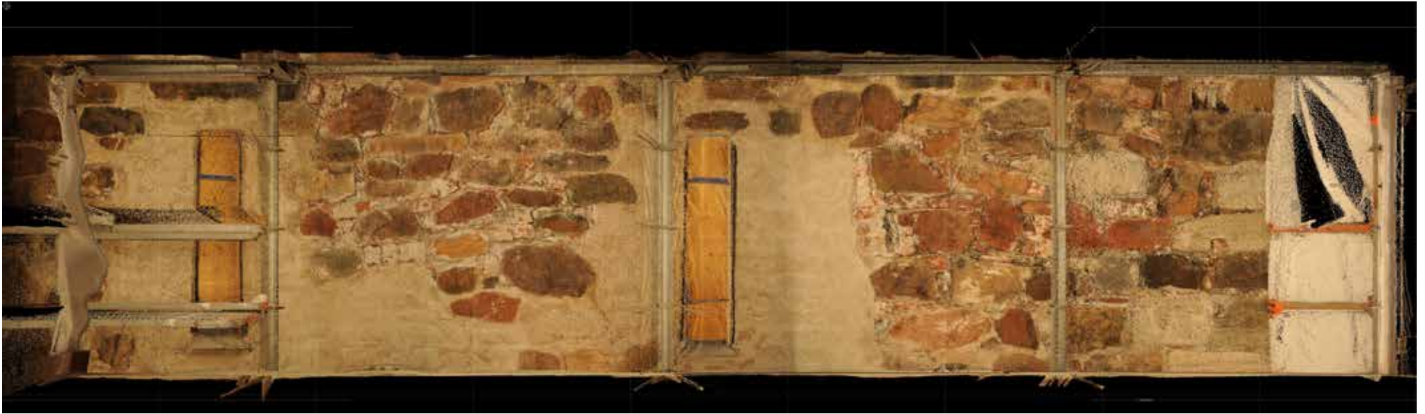
Karttakuva 3. Telinetaso 6. syksy 2017. Alakuvassa punainen alue on yli 25 cm:n syvyydellä muurirakenteen pinnasta.
