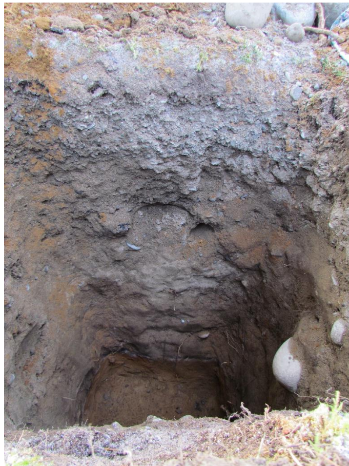
Kuva 5. Koekuopassa 39 oli täyttösora 110 cm syvyyteen. Pohjalla erottuu alkuperäinen maanpinta.
