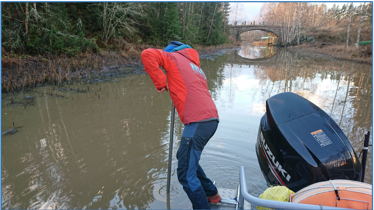
Kuva 9. Näytteitä otettiin venäläisellä suokairalla veneestä käsin.
