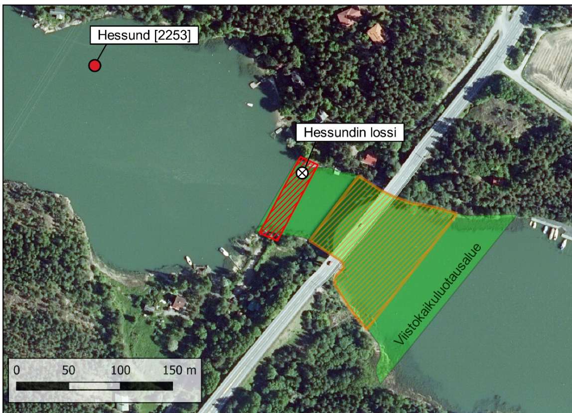
Kartta 3. Inventointialue, havainnot, ja läheisen Hessundin hylkykohteen sijainti. Viistokaikuluotauksen kattavuusalue on 40–50 m inventointialuetta laajempi. Taustakartta Maanmittauslaitoksen Ortoilmakuva 4/2020 aineistoja. Laatija: Aki Hakonen.
