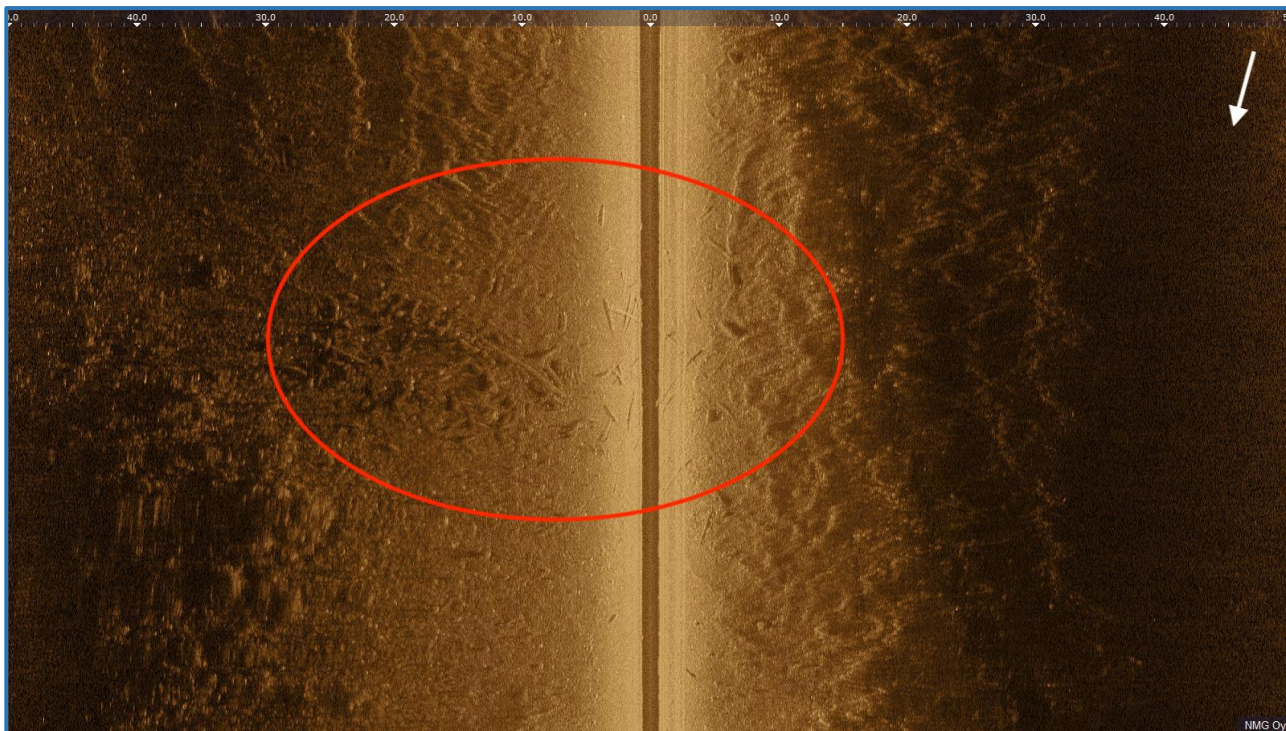
Kuva 7. Viistokaikuluotauskuva kohteesta 2. Puutavaraa noin 20 x 30 metrin alueella pohjassa.
