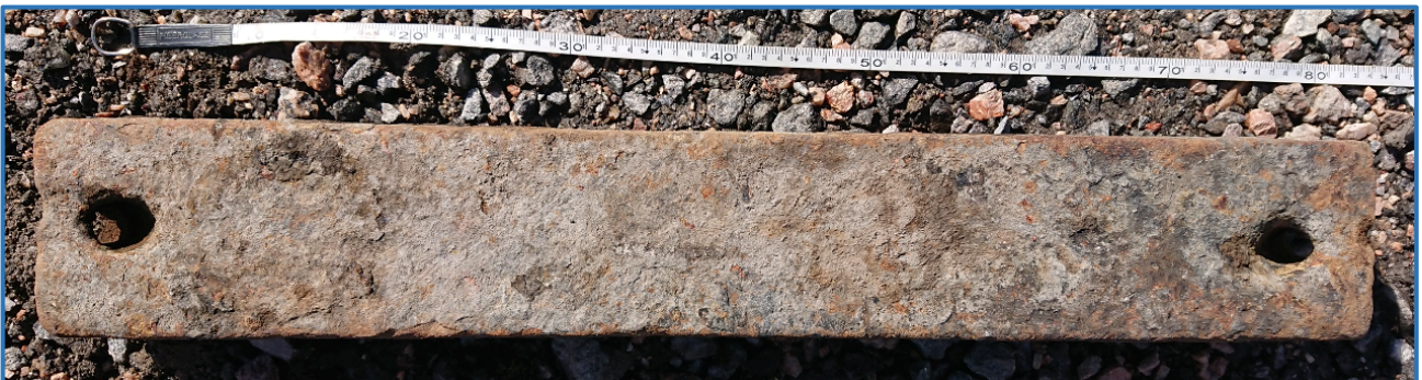
Kuva 7. Rautainen sukellusveneen painolastiharkko. Päissä on reiät läpi harkon päätyihin.
