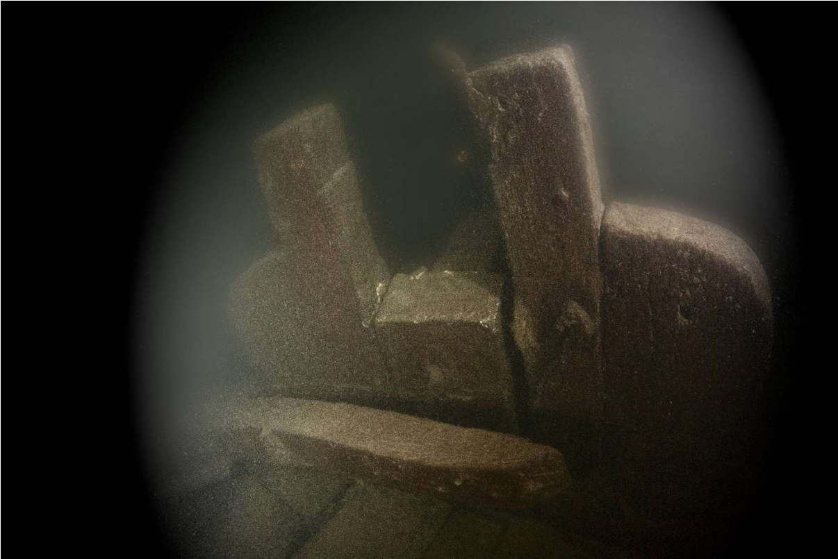
Keulassa sijaitsevat pukspröötin tuet sisäpuolelta kuvattuna.
