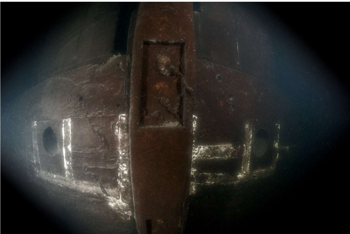
Keulan yläosa, keulasteevi keskellä, sivuilla klyyssit. Ilmeisesti lyijystä tehdyt listat.
