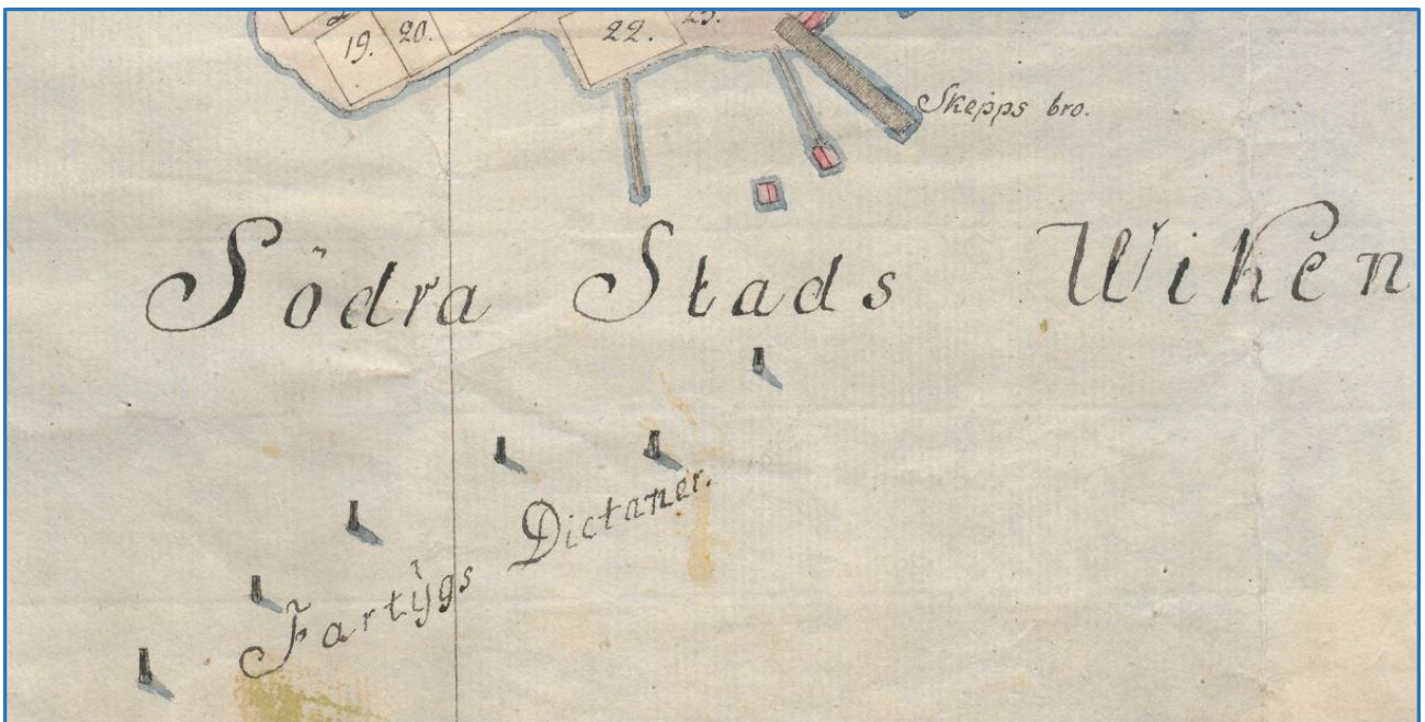
Kartta 6. Karttaote vuoden 1798 kartasta Tammissaaren Södra Vikenin alueelta. Lahden suulla sijaitsee redialue, missä on kuusi diktaalia, "Fartygs Dictaner". Diktaalit ovat oletettavasti olleet pohjaan juntattuja pyöreitä hirssiä, jotka on kiinnitetty yläosastaan toisiinsa kiinni. Kartta Kansallisarkiston digitaaliarkisto: Geometrisk_karta_öfver_Eknäs_stad_belägen_uti_Nyland_Raseborgs_Västra_Härad_och_Pojo_socken_1.
