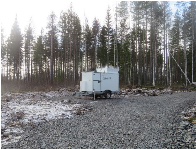
Kuva 13. Doppler-Lidar mittauslaite Lehmikiven Yläharjulla tuulimittaustornin vieressä.
