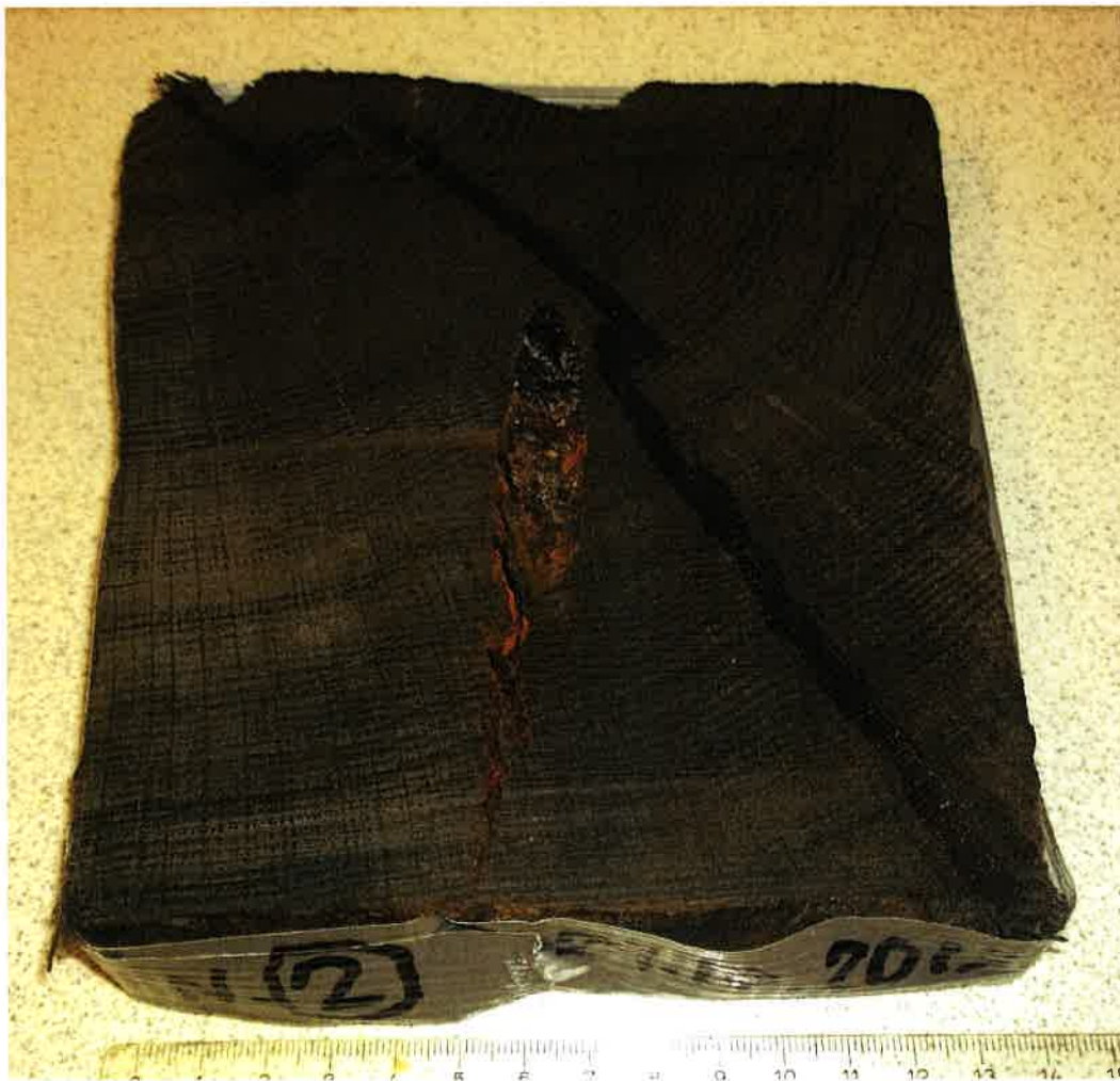
Liitekuva 4. Vaasan Grönvikin laivahylyn hirren poikkleikkauskiekko (näyte F5V3801).
