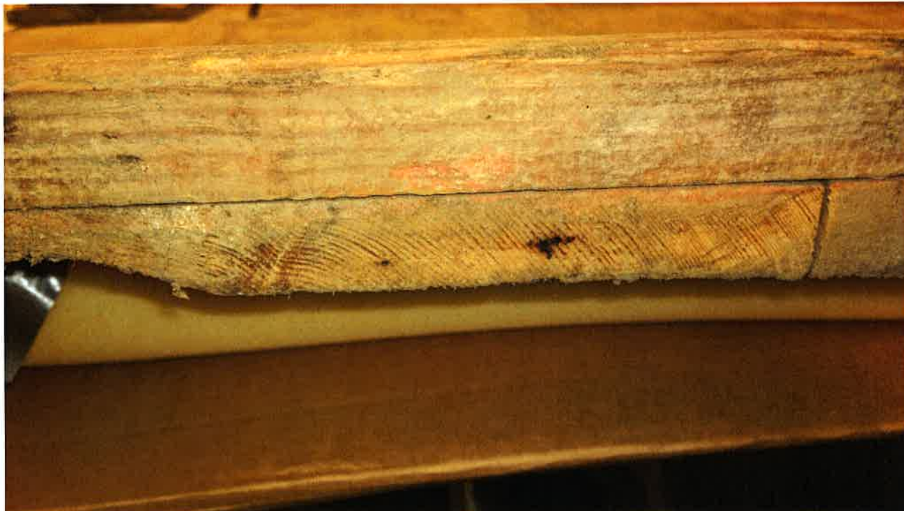
Liitekuva 1. Isokyrön kirkon votiivitalun pohjalaudan vuosilustot (näyte FIV1024).
