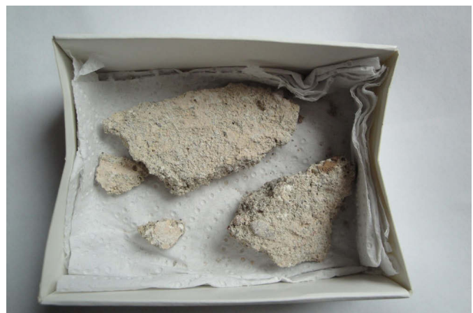
Tamminiemen rappaus- ja maalinäyte, mahdollisesti vuoden 1904 materiaalia. Museovirasto. Kuva Tiina Sonninen 2010. Rakennuksen julkisivulta otetusta rappaus- ja maalinäytteestä tehtiin kaksi erillistä mikroskooppinäytettä. Näytteet otettiin pinnassa säilyneestä vaaleasta lähes rappauksen sävyisestä maalipinnasta. Tutkimukset suoritti Konservointi T. Sonninen Oy
