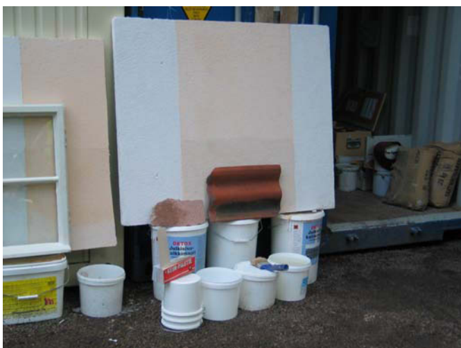
Kalkkimaan värimallikatselmus. Kattotiilen sävy on otettava huomioon. Vasemmalla julkisivusta purettu pala 1970-luvun läpivärjättyä Terrasit-laastia. MS 26.8.2010
