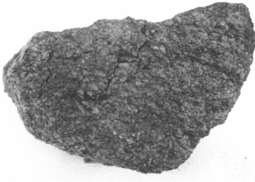
Kuva 4. Oulu Oulunsuu Talvikangas 1. Koepistosta löytynyt, palanut graniittikivi. Huomaa kovan kuumuuden aiheuttama halkeilu (kuva 6).
