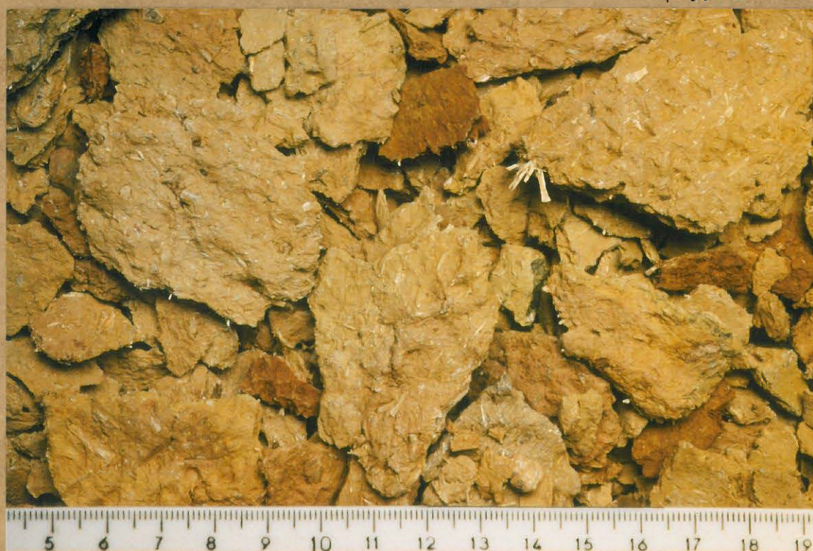
KM 20314. Varhaista asbestilamellulaa. KUVA 22
