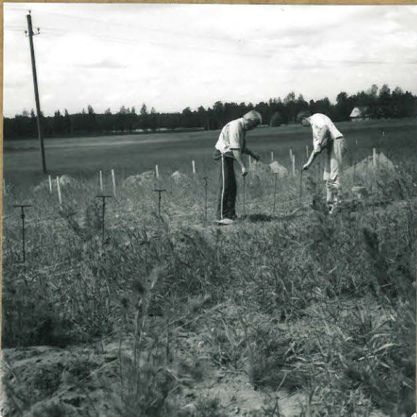
F 77332 Jalle Tammenmaa ja Jussi Aalto Teknillisestä korkeakoulusta suorittamassa maavastusmittauksia
