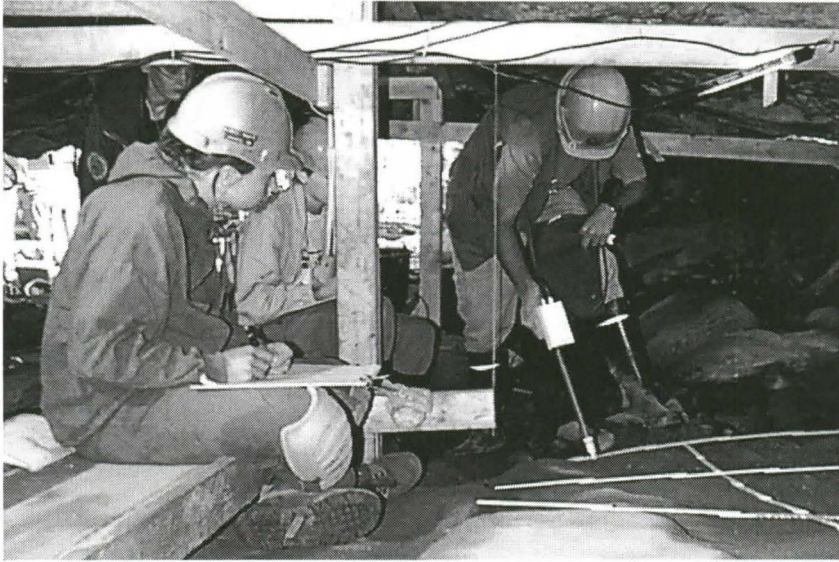
Kuva 26. S-98/47 Työkuva; magneettisia susceptibiliteetimittauksia ruuduissa 53-54/20-21. Kuvassa vasemmalta J. Itäpalo, A. Kaakinen ja J.-P. Lunkka.
