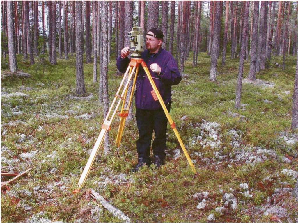
Kuva 060. Takymetrimittaus. Kuvassa Marcus Riska, kuv. H.-P. Schulz.
