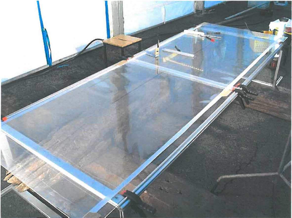
Kuva 3. Piirtopöytä, jonka avulla rakenneosia piirrettiin 1:1 muoville. Kuva 2005:843:060, kuvaaja A. Aartolahti.
