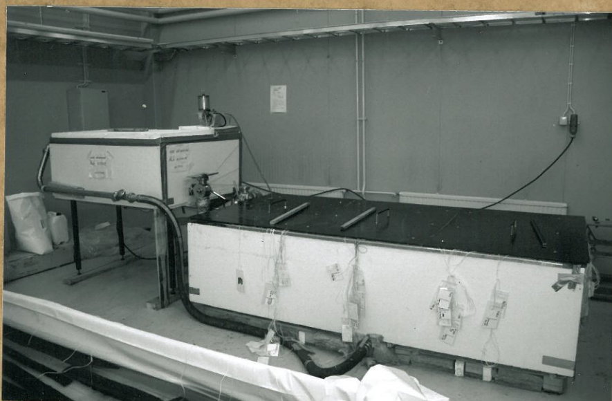
110386 Kuva 102. Yli-Jin teollisuus halli 3; kuvassa "Pegarr36" konservointilaitte, oikealla PEG-allas.
