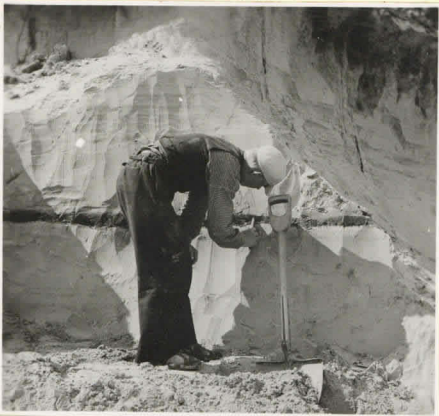
11. Turvejuovan per- kaaminen maan- näytteen ottamista varten.
