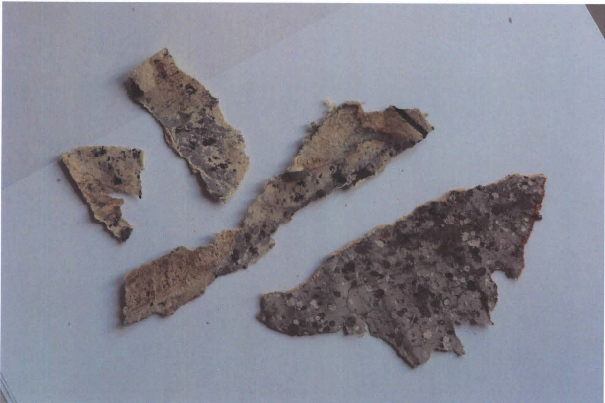
Eteisestä ja porrastilasta löytynyt alkuperäistä, hirteen liimattua, siniharmaata roiskemaalitapetin fragmenttia. Roisketapetti oli hyvin tyypillinen eteisissä, keittiöissä ja pienissä välihuoneissa 1700-luvun lopulla ja 1800-luvun alkupuolella.
