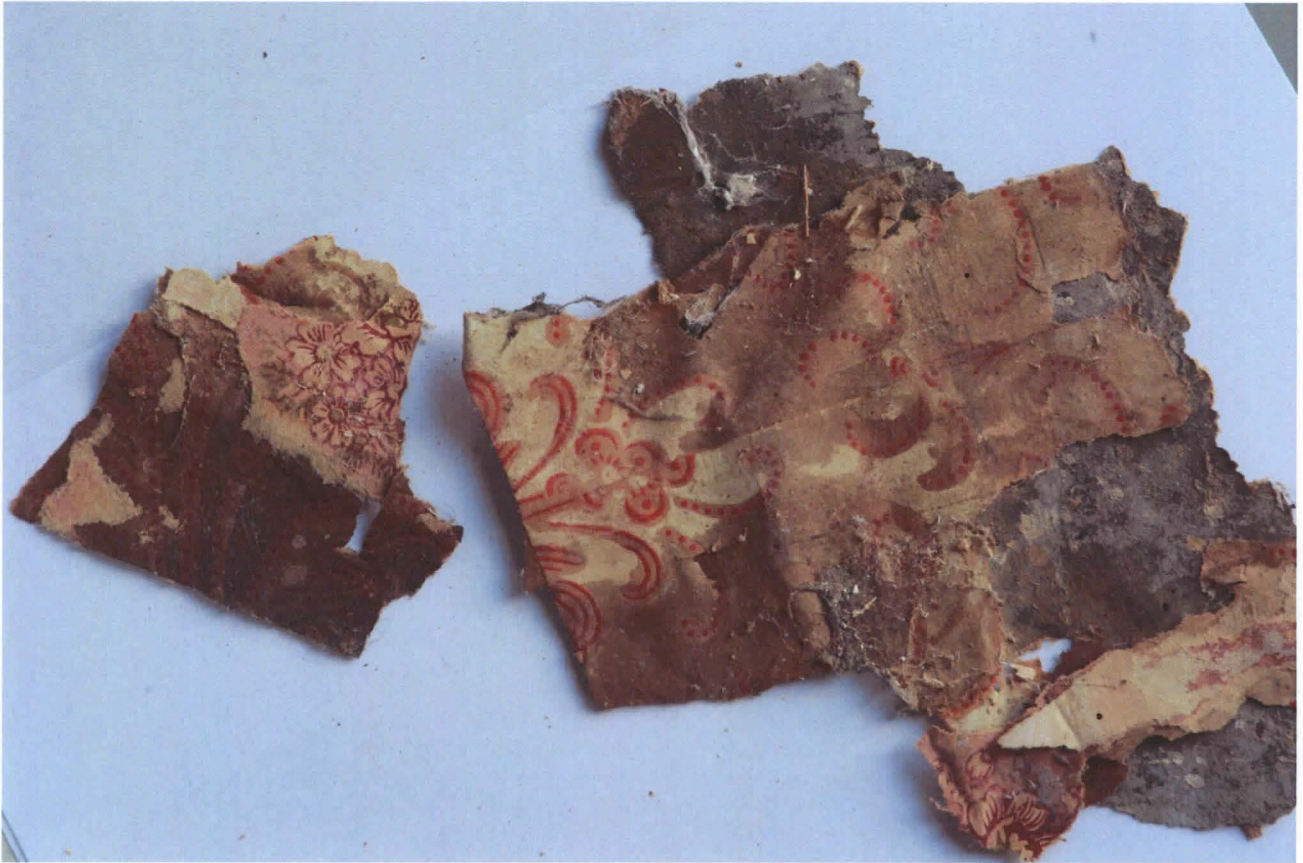
Siniharmaan roiskemaalitapetin päälle liimattuja 1800-luvun lopun tapettikerroksia.
