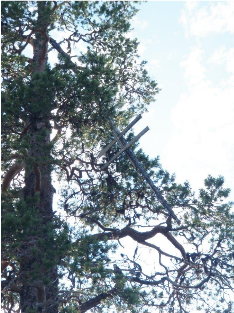
Ranta-Vuonnonselkä 1 kolmiomittauksen puunlatvamerkki. Kuva: J. Puikko.
