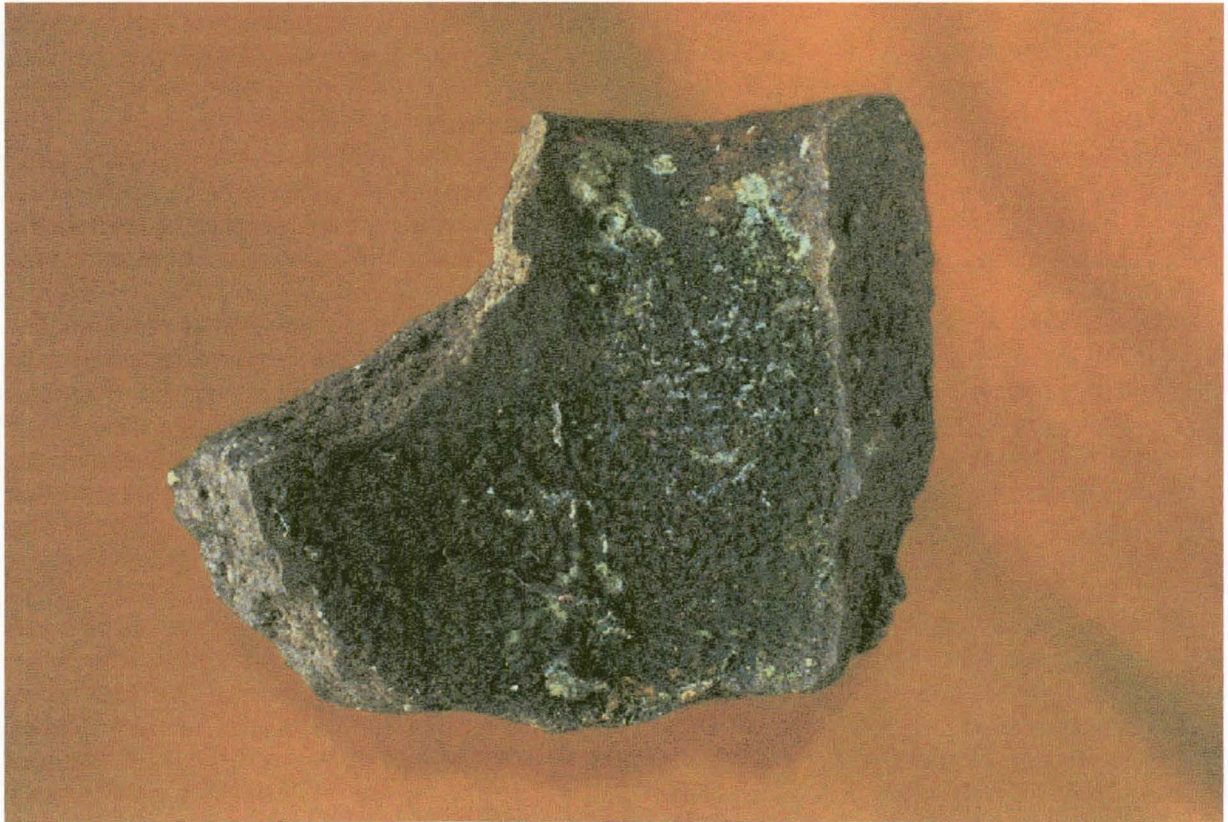
F99103. Degelfragment med rest av smälta i grön ton, troligen pga innehåll av koppar. Förstoring ca 2,9 ggr. Foto: Mikael Herrgård
