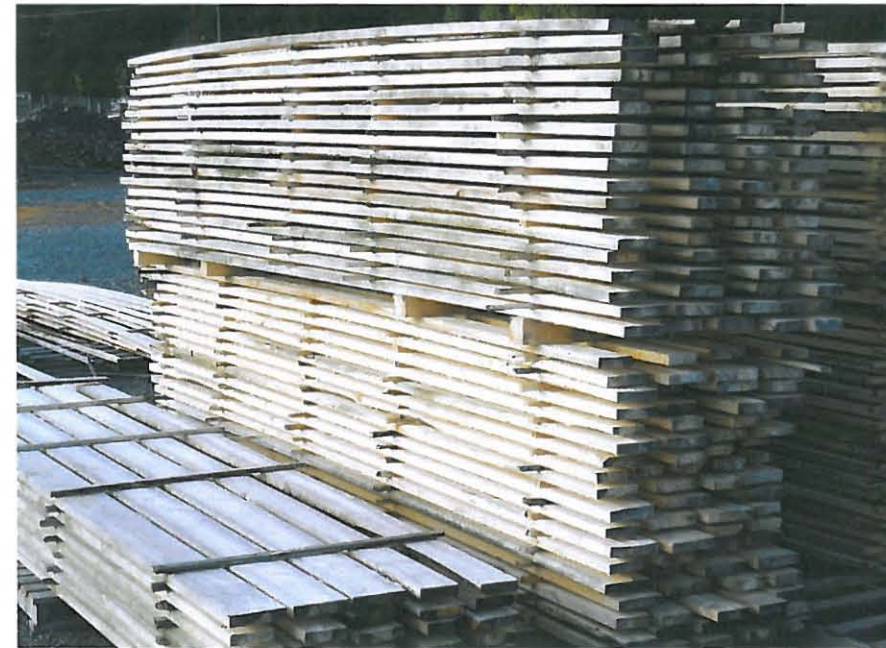
Lautakalteen vuotamattomuus edellyttää suoria lautoja. Kuvassa laudat vaikuttavat kaareutuvan erityisesti pinon yläosassa ja keskivaiheilla.
