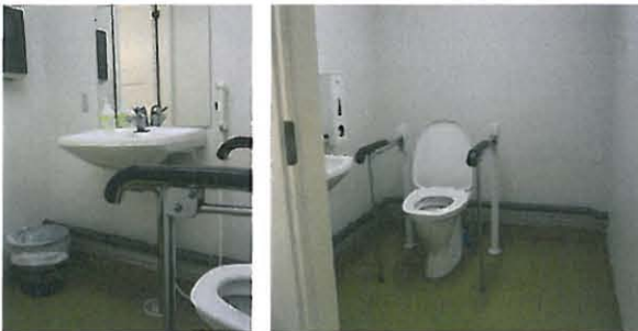
Kuva 37: WC:n kalusteet, peili ja paperiteline on kaikki sijoitettu oikein ja suositusten mukaisesti, mutta tila on isommille tuoleille ahdas.
