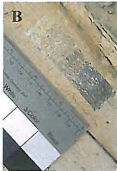
B Väriportaikko räystäslistan suorassa laudassa,
