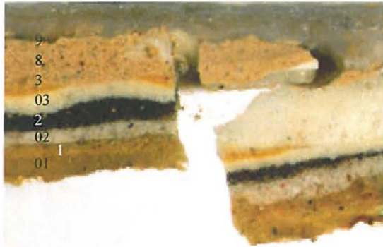
Ikkunan vuorilaudoitus, palmetin ulkoreuna (PyIVu12_4x). Kerroksia puuttuu.
