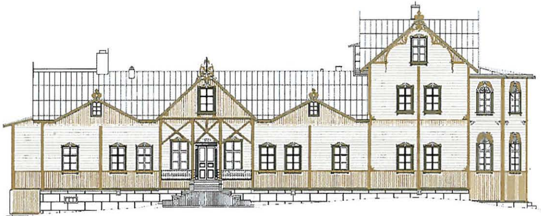
Kuva 5. Julkisivu kaakkoon. Pytingin kolmas värikerros. Seinä ovat kellanvalkoinen ja listoitus kellanruskea, samoin kuin rintapaneelin ja ylemmän seinäpaneelin pystyrimalaudoituksen rimat. Koillispuolella pitäisi olla avoparveke, joka on vasta myöhemmin ummistettu.
