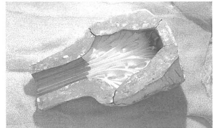
Keskitornin muotti avattuna ja koottuna. Tummat kappaleet ovat shellakattua kipsiä, vaalea osa silikonia.
