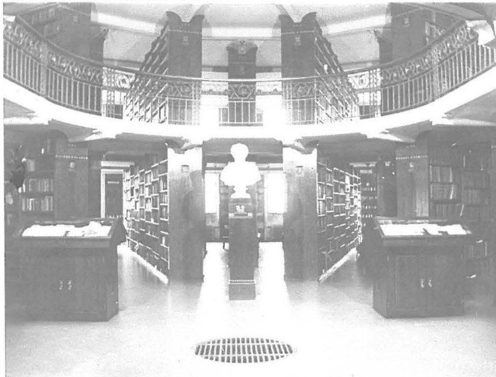
Valoaukon keskellä lattiassa oleva ritilä on ollut lämmitysjärjestelmän sisäänpuhallusaukko. Otava
