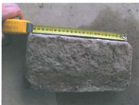
KUVA 12. Ampuma-aukkojen korjaukseen käytettävä tiili.
