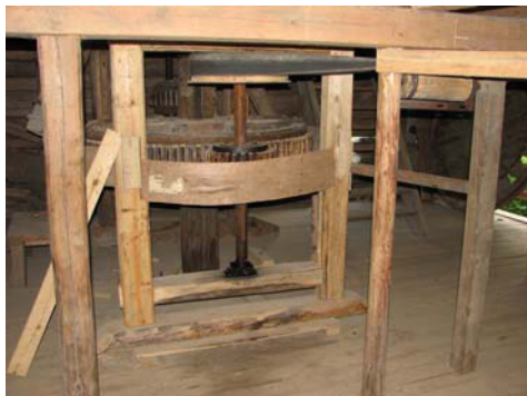
Kuva 54. Alakerros, käytössä oleva hammasratas (nro 011).
