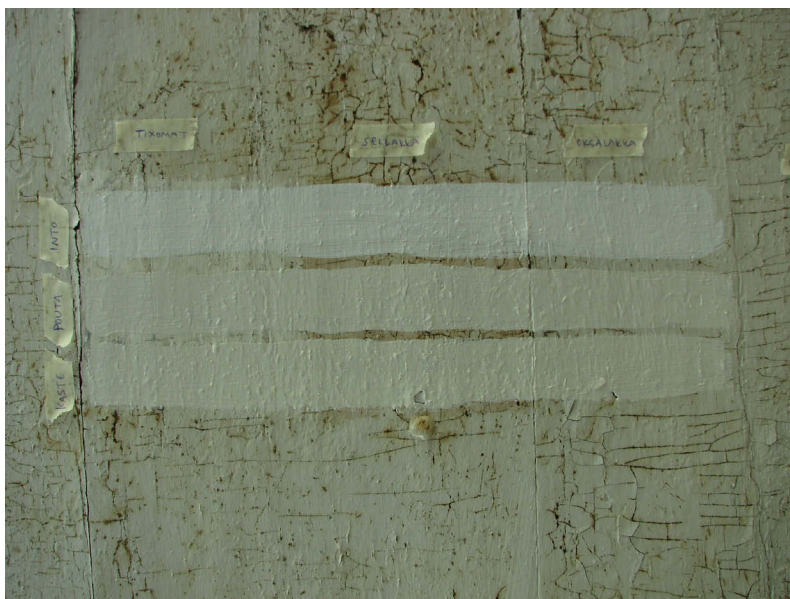
Kuva 26: Katon koealue jaettiin kolmeen osaan. Eristekerroksina vasemmalta oikealle Tikkurila Tixomat, Kremer sellakka ja Tikkurila oksalakka. Peittomaalit ylhäältä alas Uula Into öljydispersio-maali, Uula pellavaöljy-maali sävy pouta ja Uula pellavaöljy-maali sävy kaste.
